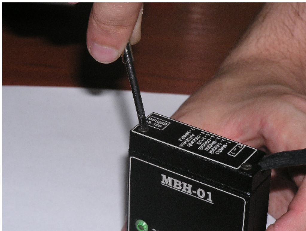
Рисунок 3.2 Снятие крышки для замены видеокабеля.
