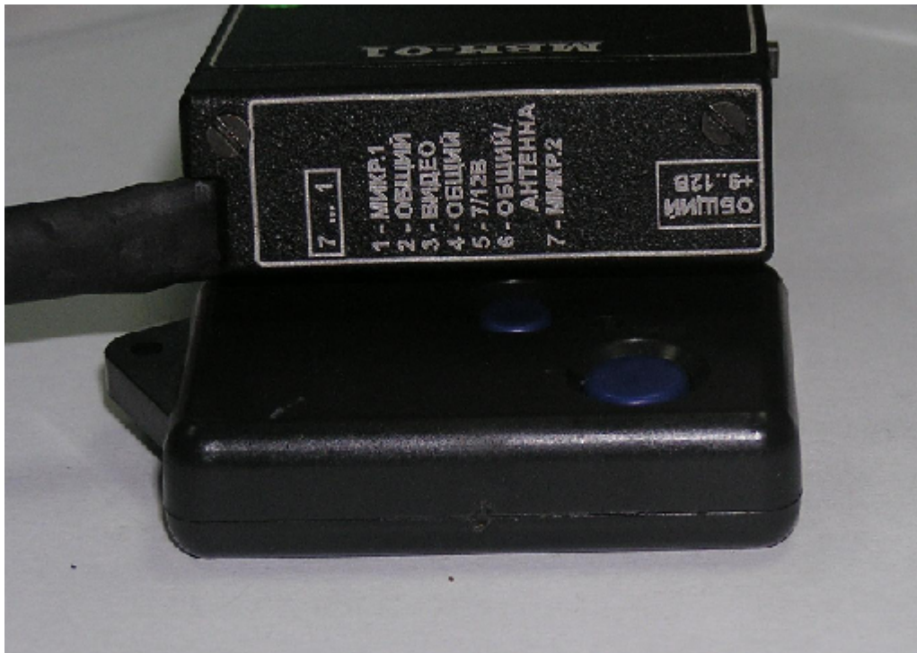
Рисунок 3.4 Назначение контактов видеокабеля.
